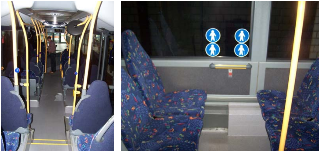
Abbildung 8: Beispiel für visuell kontrastierende Gestaltung zwischen Boden und Sitzen, von Stufen und von Festhaltevorrichtungen
