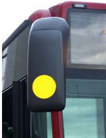
Abbildung 11: Beispiele für die visuell kontrastierende Markierung von vorstehenden Bauteilen
