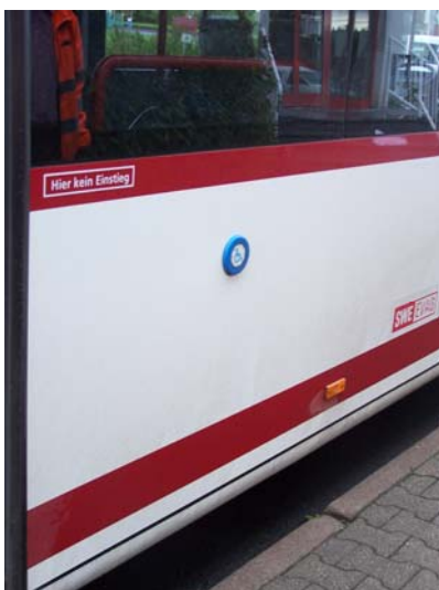
Abbildung 3: visuell kontrastierender Anforderungstaster an der Fahrzeugaußenseite
